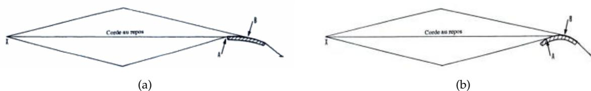
FIGURE A.1 – Schéma d'une corde en présence d'un chevalet courbe en position (a) fermée (b) ouverte.
