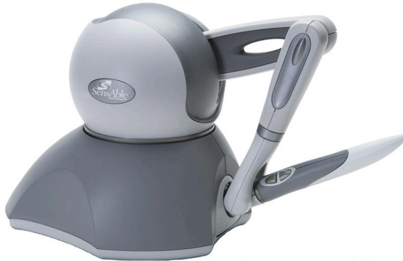
FIGURE 3.26 – Le bras haptique PHANTOM Omni.
