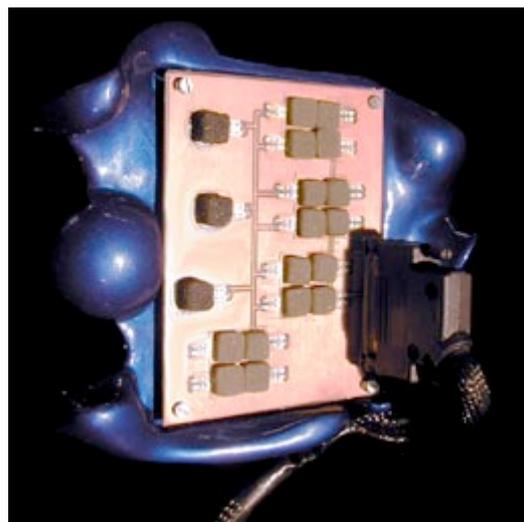
FIGURE 3.24 – *Détails des capteurs de la main droite*
