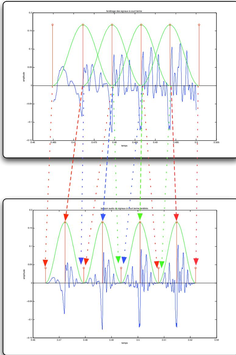
FIGURE 2.2 – Fenêtrage et constitution du tampon audio
