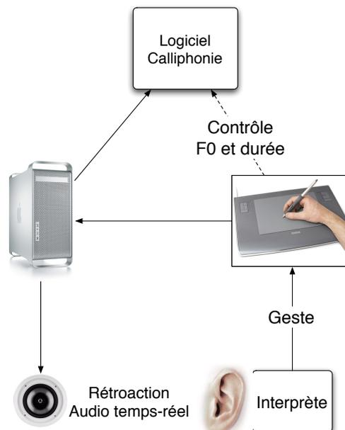
FIGURE 2.5 – Diagramme générique du système de modification prosodique (Le Beux et al., 2007)
