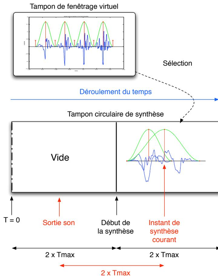
FIGURE 2.4 – Fonctionnement du tampon circulaire pour la synthèse.
