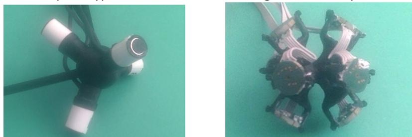
**Figure 1** : Capteurs microphoniques pour la capture de la pression et la vitesse particulière
